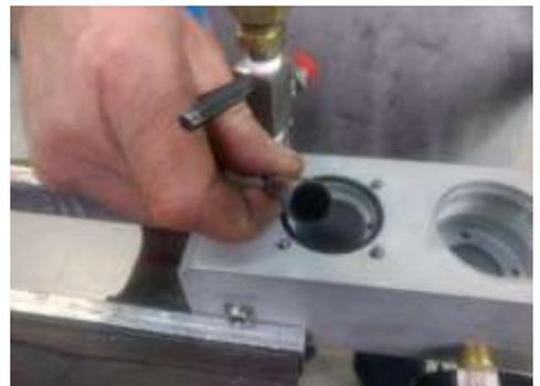
5) Para desmontar o diafragma é necessária uma ferramenta allen 4mm (ou similar) e uma chave 10mm.
