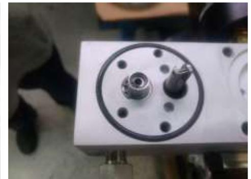
3) Vire o piloto de cabeça para baixo, remova o cartucho do piloto (chave de 7/8", 1.1/2" e chave allen 5 mm).
