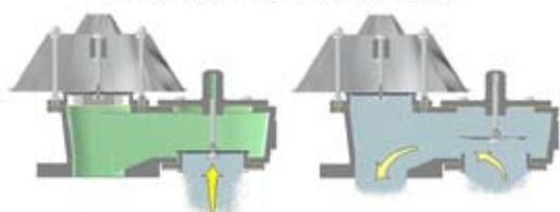
Así como también cumplen integralmente con las normas nacionales emitidas por petróleos Mexicanos NRF-113-PEMEX-2007 y NRF-172-PEMEX-2007, concebidas para regular y probar estos dispositivos. La protección típica a un tanque de almacenamiento es la combinación de esta válvula de venteo montada sobre un arrestador de flama, a este conjunto se le llama Equipo de Venteo.
