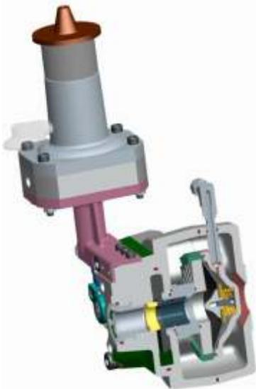
Conjunto Argos W.A. + KN (Regulador de Pressão + Válvula de Bloqueio) possui poucos componentes internos tornando a manutenção rápida e fácil.
