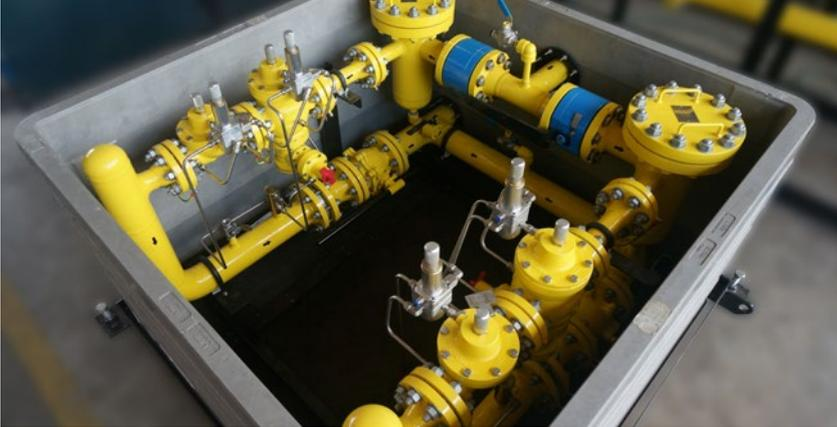
Estação Distrital de Calçada, compacta, montada dentro de uma caixa especial para instalação enterrada com tampa em ferro fundido, fabricada conforme norma para suportar até 12,5 kN. A estação é dimensionada para vazões da ordem de 2.500 a 5.000 Nm<sup>3</sup>/h, reduzindo de 15 kgf/cm<sup>2</sup> para 4 kgf/cm<sup>2</sup>. Possui 2 tramos de regulação e configuração ativo / monitor.
